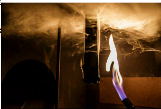
ISO 340 Fire test at Dunlop's laboratory / ダンロップのラボでのISO340のテスト
