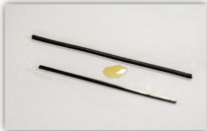
EFFECTOS DEL ACEITE SOBRE EL CAUCHO
